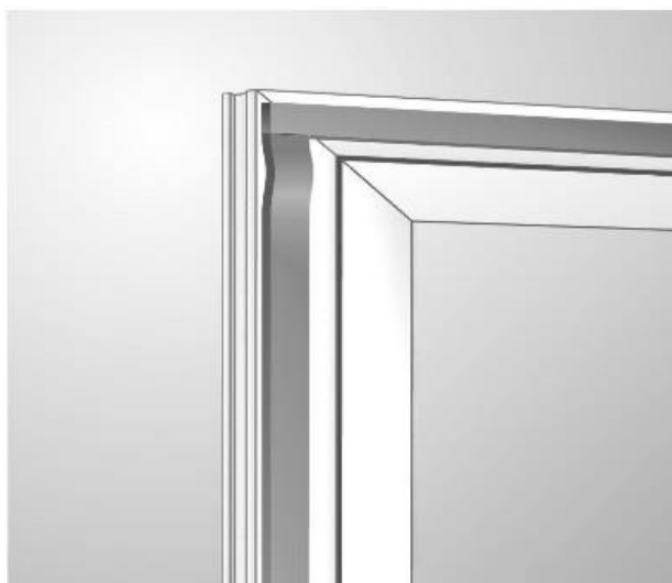
fig. 1 : réalisation de joints au niveau des compribandes
