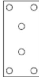
Figure 2a : plans de chevillage – panneaux de dimensions 1000 x 500 mm
