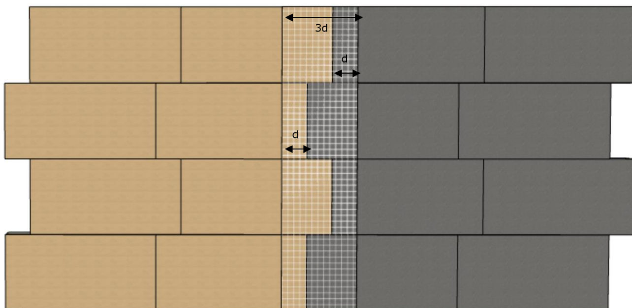
A. Jonction entre panneaux en PSE et panneaux de dimensions 1200 x 600 mm de nature différente (en laine de roche ou fibres de bois)
