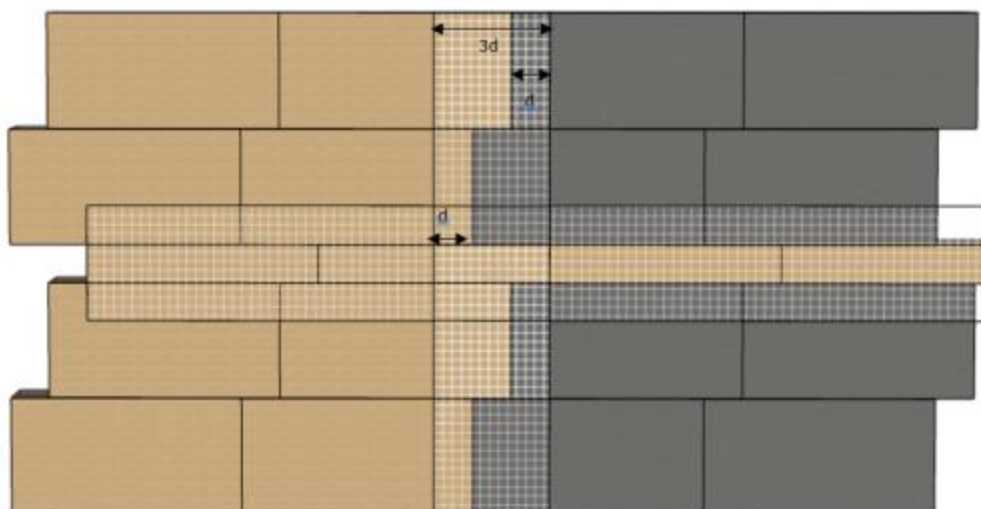
Figure 7a : Jonction entre des panneaux PSE avec un autre isolant 1200 x 600 mm avec bande coupe-feu d \geq 200 mm
