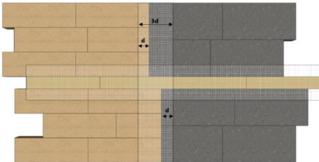
Figure 6b : Système StoTherm Minéral 1 avec panneaux en laine de roche de dimensions 400 x 1200 mm
