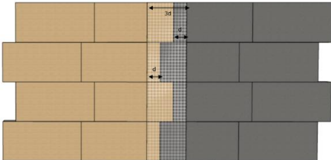
Figure 4a : Système StoTherm Minéral 1 avec panneaux en laine de roche de dimensions 600 x 1200 mm
